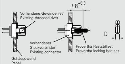
Variante B: Anbauset für vorhandenen Steckverbindern mit Gewinde auf der Lötsseite.
